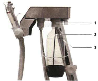
Abb. 1) Montagebeispiel: Wasserflasche am Behandlungsgerät
